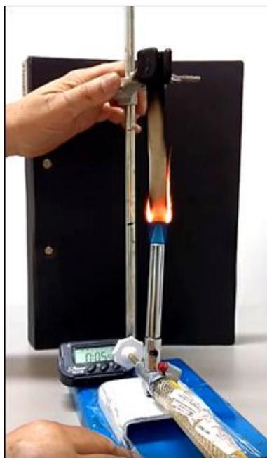
*UL 94: teste de queima de corpo-de-prova produzido com o novo gelcoat da Dilutec*
