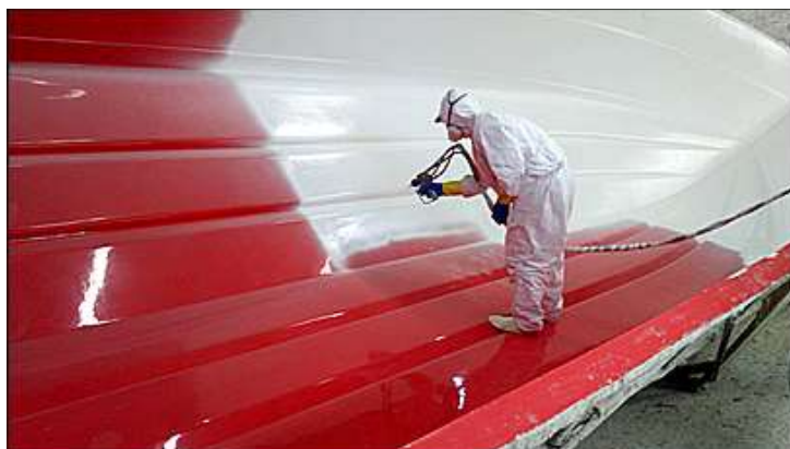
Fabricação de barco com o gelcoat branco da Dilutec
